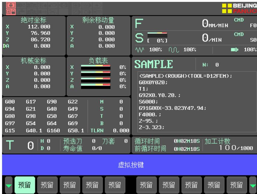
此外，提供了与各按键对应的 E 地址（状态地址）。在完成指定按键操作后，通过编写 PMC 程序，将对应操作的完成状态信号导通到该虚拟按钮的输出 E 地址。在 E 地址处于 ON 状态时，按键颜色切换为绿色（请见上图），类似于物理机床操作面板上的指示灯点亮，表示虚拟按钮对应的操作已经执行完成。
