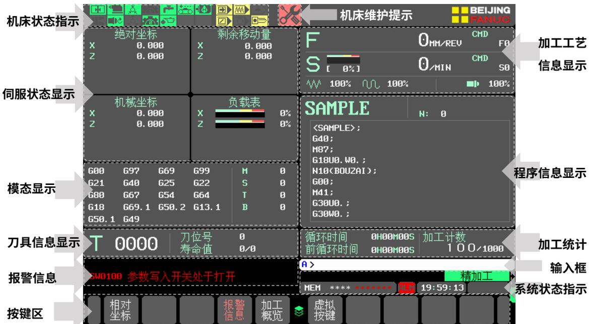
图 3-2-4.2 车削版机床加工状态检查界面信息显示区说明
