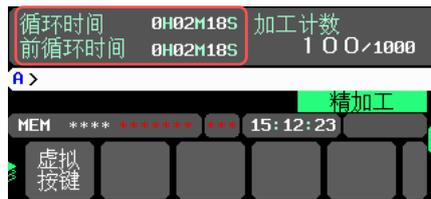
通过记录前循环时间，可以记录当前加工程序的一般加工时长，用于后续连续加工中时间的对比，预估当前循环执行进度，或通过循环时间判断加工工艺是否较原工艺发生改变。
