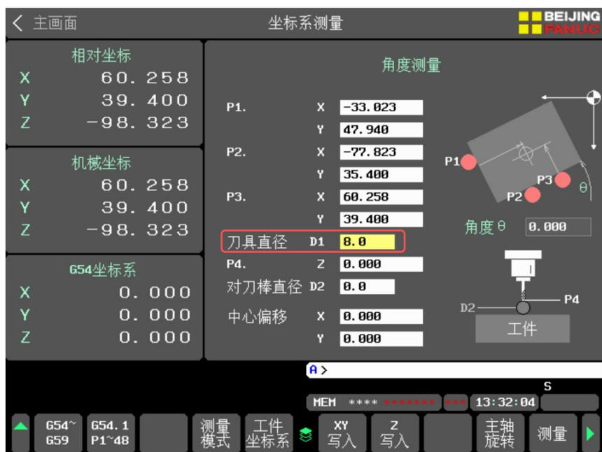
⑦ 如果使用对刀棒进行 Z 轴对刀，对刀前需要在“对刀棒直径 D”中输入对刀棒直径值。
