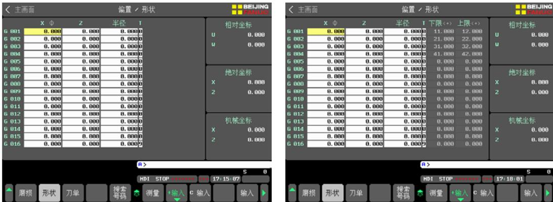
图 4-1-4.2 偏置/形状界面 ([+输入]上下限隐藏/显示)
