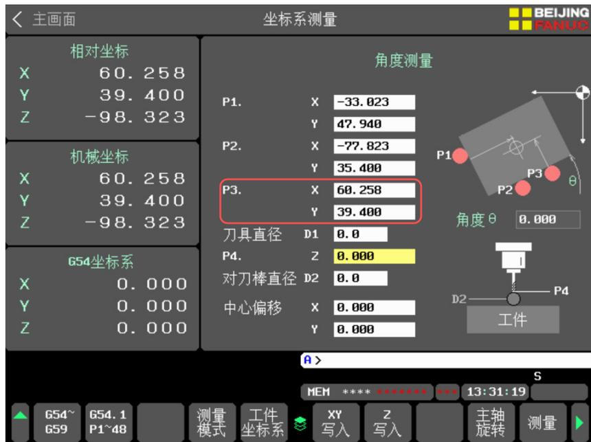
⑥ 在“刀具直径”输入框输入测量用刀具的直径值。
