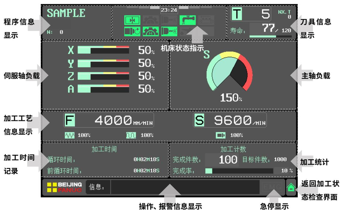
图 3-2-5.1 铣削版机床加工状态概览界面
