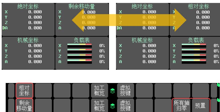
在相对坐标显示状态，右下方将显示与相对坐标操作相关的按键[所有轴归零]和[预置]。通过按键操作可以完成对相对坐标值的修改。
