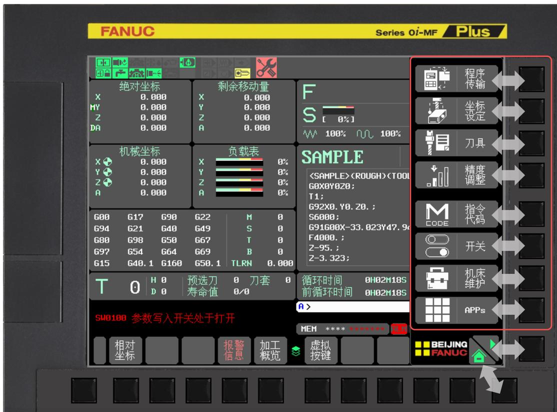
图 3-2-6.1 侧边栏菜单栏功能按钮与竖排按键之间的关系示意
