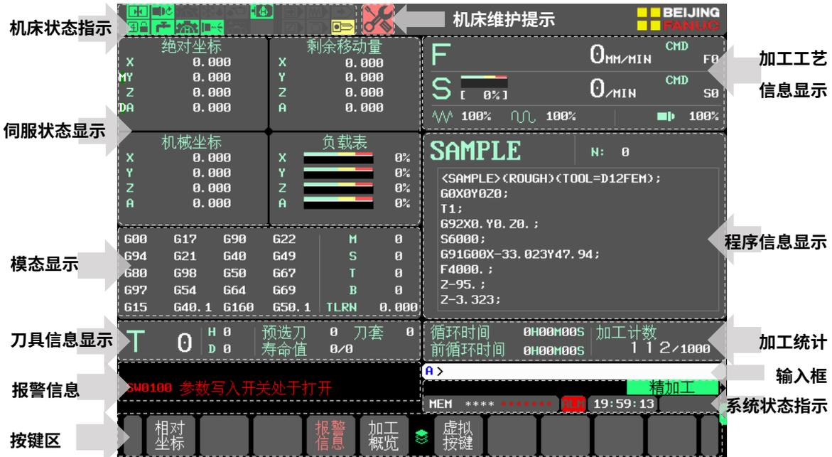
图 3-2-4.1 铣削版机床加工状态检查界面信息显示区说明
