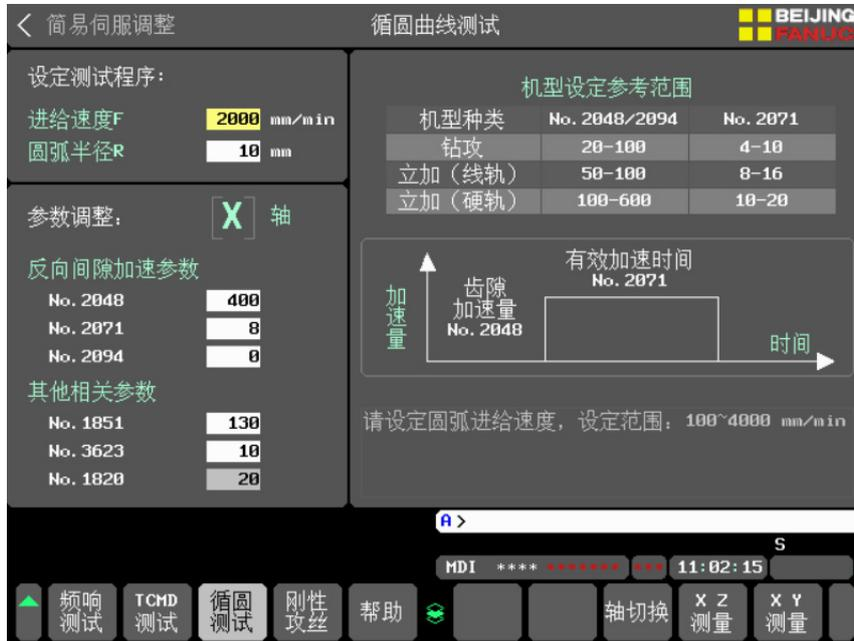
图 4-3-3.5 循圆曲线测试界面
