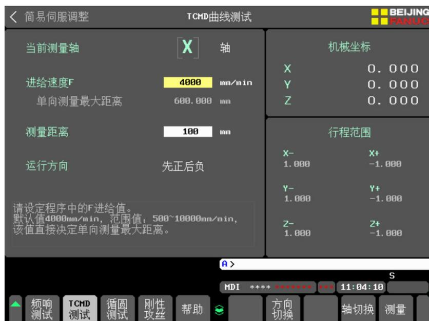
图 4-3-3.4 TCMD 曲线测试界面
