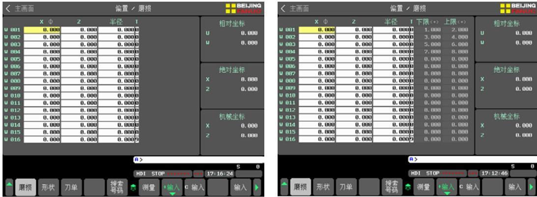
图 4-1-4.1 偏置/磨损界面 ([+输入]上下限隐藏/显示)
