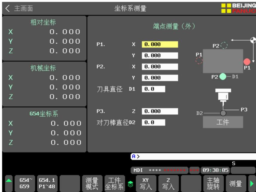
图 4-1-2.2 端点测量（外）界面
