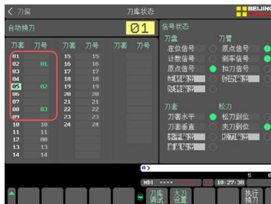
在使用刀库状态功能前，需要首先完成刀库相关信号与功能界面之间的链接。这部分工作主要涉及 PMC 程序的编写，处理方法如下。
