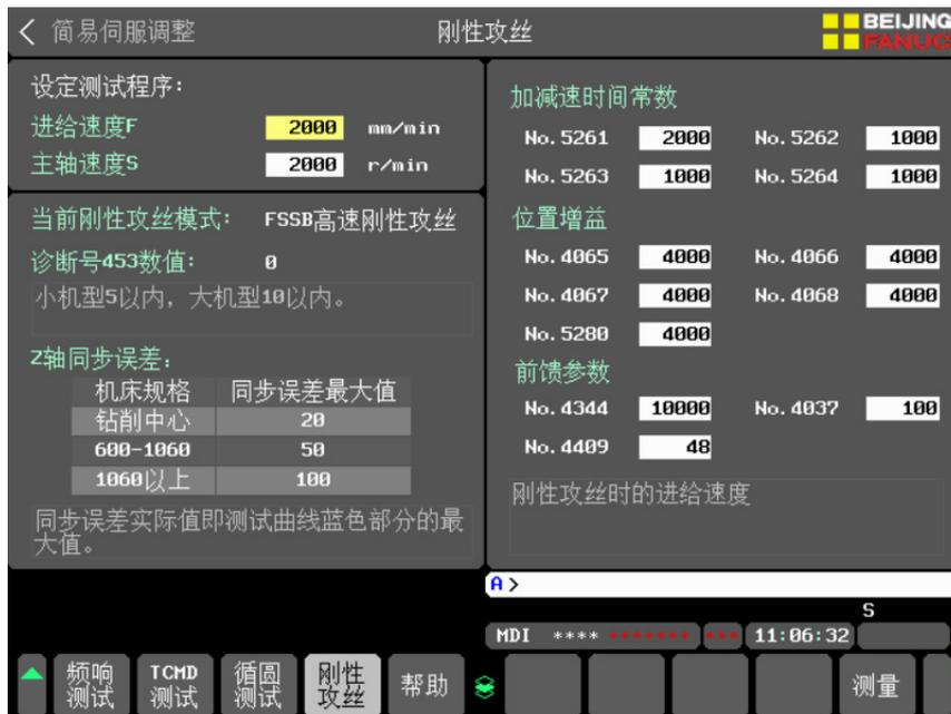
图 4-3-3.6 刚性攻丝测试界面
