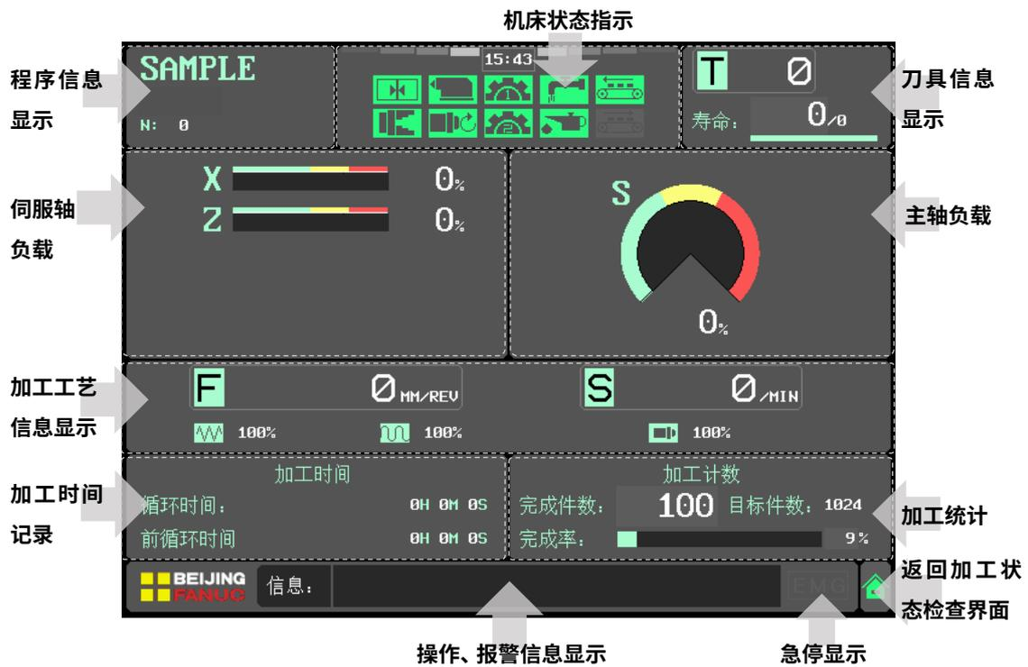
图 3-2-5.2 车削版机床加工状态概览界面
