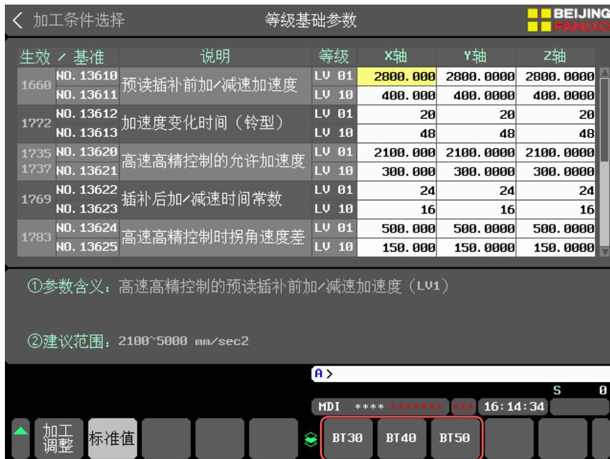
点击[BT30]、[BT40]、[BT50]任意软键，则会有操作确认弹窗提示。点击[确认]软键，待提示弹窗自动擦除后即完成标准值的设定。
