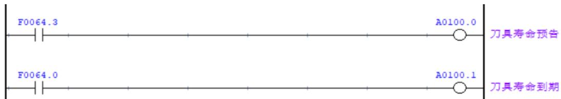
刀单画面下的刀具寿命功能在实际使用时需要配合 NC 指令的修改，否则不能计数。在刀具寿命初始化时，每把刀的刀编号与刀号一致（如 T0101）。如有个性化需求，请在 FANUC 原界面内的“刀具寿命”画面下进行修改。
